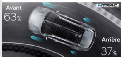
Système de traction intégrale dans le tournant (HTRAC)
